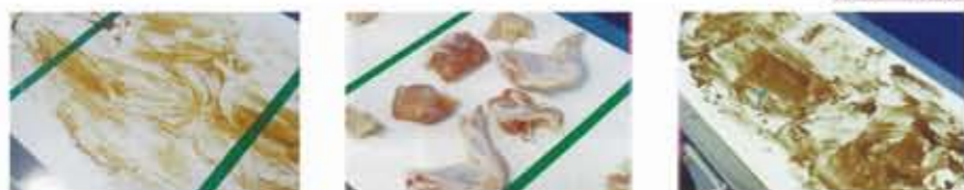
味噌 洗浄前 約65,000 (RLU) → 洗浄後 30 (RLU) 鶏肉 洗浄前 約27,000 (RLU) → 洗浄後 331 (RLU) チョコレート 洗浄前 約15,000 (RLU) → 洗浄後 23 (RLU)
